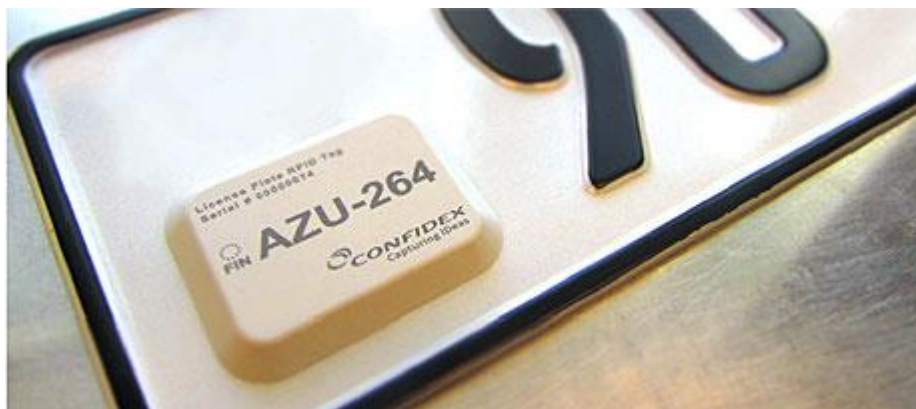
Чип компании Confidex на автомобильном номере
