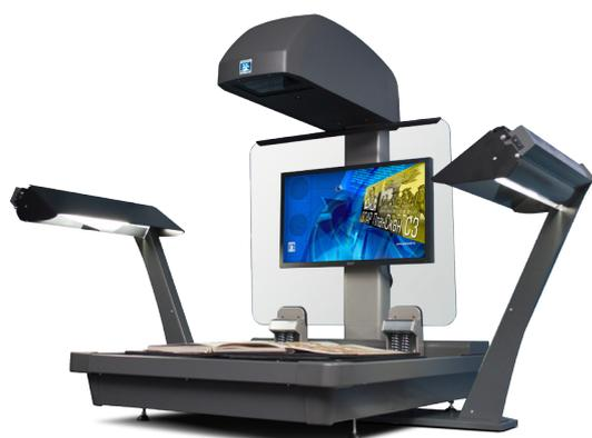
нирующая линейка, либо, как в нашем случае, матрицы. В сканерах, использовавшихся при обработке документов в ЦАМО, установлено по три 80-Мпикс матрицы RGB. Они захватывают область чуть больше формата А3, что позволяет сканировать за один цикл два стандартных листа размера А4.
